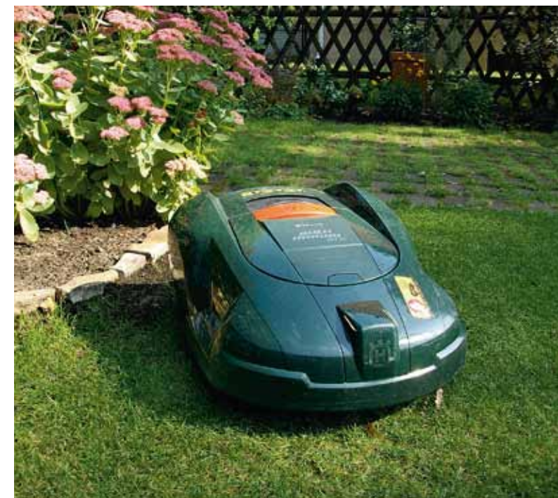
Anstoßen gehört bei Dolly zur Arbeitsweise. Dann wechselt sie die Richtung.
