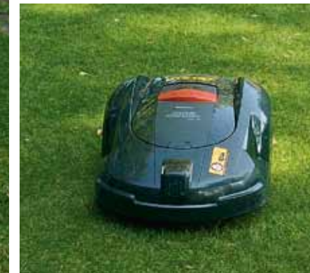
Der Mäher fährt nach dem Zufallsprinzip kreuz und quer über die Rasenfläche.
